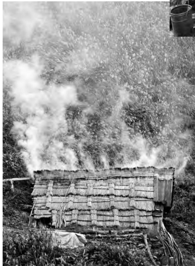
煙を上げる炭焼き窯。煙の色で窯の中の温度を判定し火を止める時間を見極めた。タイミングがずれると原木は灰になってしまう。炭は窯から出して俵に詰め、4~5俵を背負い、何時間もかけて林道ちかくまで運び出した。原木が尽きると3~4年で別の場所に新しい窯を築いた。半明で(1980年)
